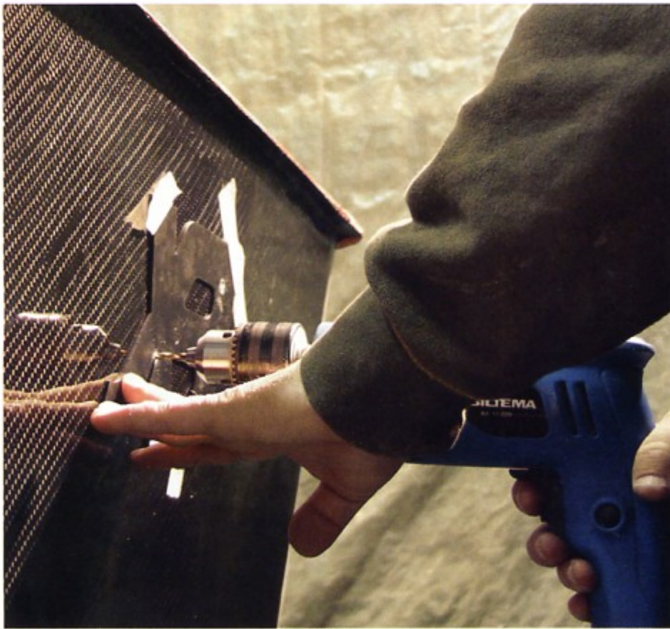
10 Efter ett par dagar kunde vi använda den medföljande mallen till att markera och borra upp de fyra hålen i den nylackade akterspegeln.
