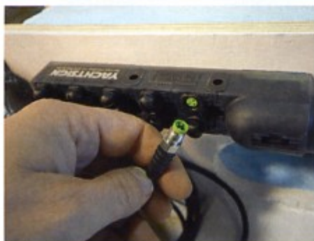
13 Snabbkopplingar gjorde inkopplingen av elen enkel på akterspegelns baksida. Enheten är gjord för att försörja upp till tio lysande bokstäver.
